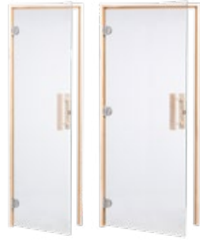
Saunatür DS40 3-seitiger Rahmen, Klarglas 8 mm ESG, Bänder links oder rechts anschlagbar Glas: 590 oder 680 x 1915 mm Rahmen Fichte: 650 oder 740 x 1960 x 40 mm Art.-Nr. DS40-3CS-590 (590 mm Breite) Art.-Nr. DS40-3CS-680 (680 mm Breite)
