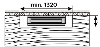
Abmessungen des Saunaofens: Breite 340 mm, Tiefe 95 mm, Höhe 680 mm, Gewicht 6 Kg
