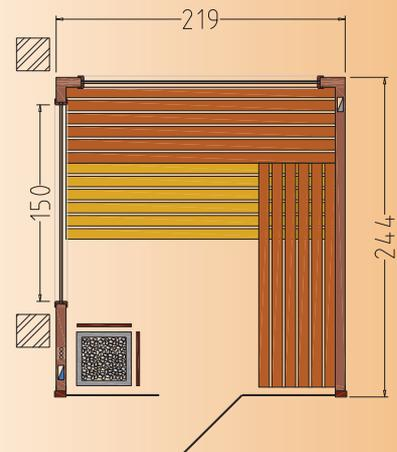
**Modell Opal.** Bei dieser Sauna wurden große horizontale Fenster realisiert, die einen Ausblick in den Weinkeller des Kunden ermöglichen. Die untere Saunabank wurde so konstruiert, dass sie einschiebbar ist und dadurch mehr Platz im Innenraum der Sauna ermöglicht.
