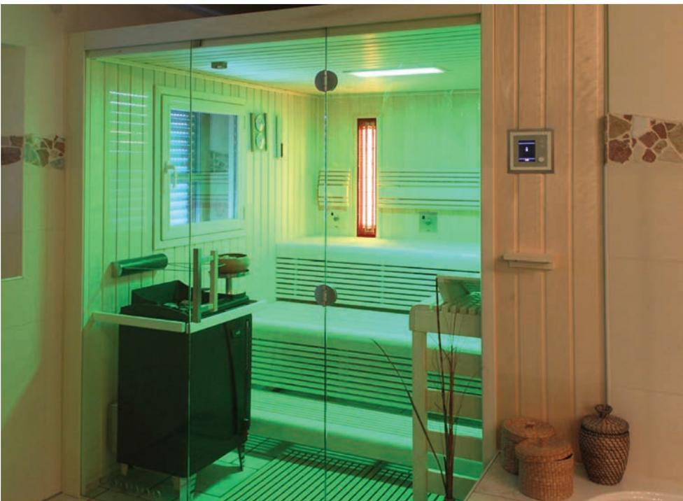
**Modell Aurora.** Bei dieser Sauna wurde ein VITAllight-RED-Infrarotstrahler auf Wunsch direkt in der Saunabank integriert. Eine weitere Besonderheit war das innenliegende Holzfenster zum Öffnen. Da sich das Fenster beinahe direkt über dem Saunaofen befand, wurde hier extra ein temperaturbeständiges Sicherheitsglas (VSG) verwendet.
